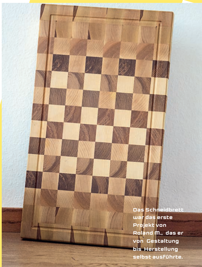
Nach dem Aushobeln wurden die einzelnen Kanten passend miteinander verleimt.
